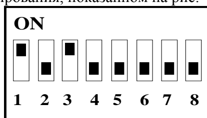
Рис. 4. Пример установки адреса БУЗ
